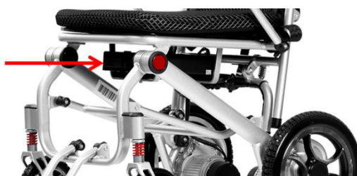
Obrázek 7: Instalace baterie do vozíku
