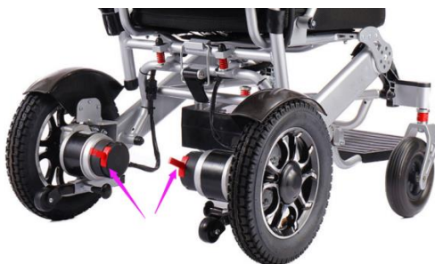
Obrázek11: Červené páčky na motorech zadních kol
