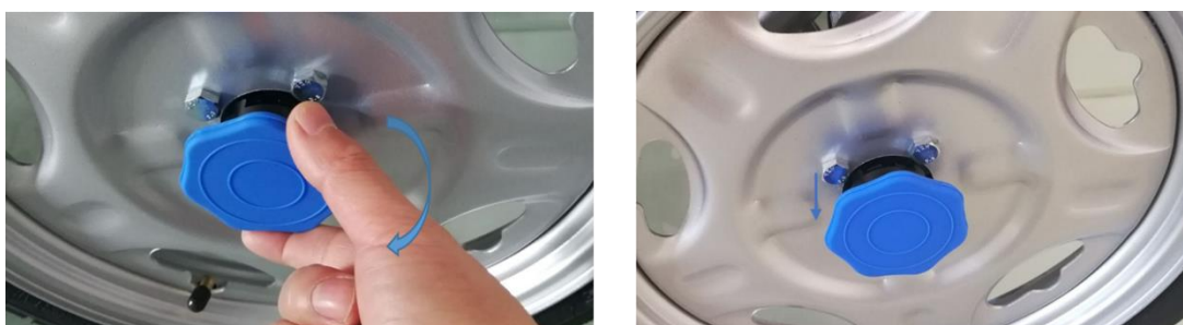
Obrázek 8: Otočení spojky při přepínání do manuálního režimu
