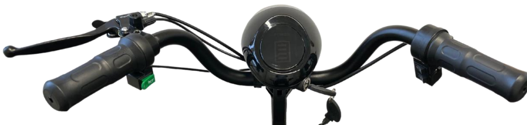
Obrázek 6: Fotografie celého ovládacího modulu
