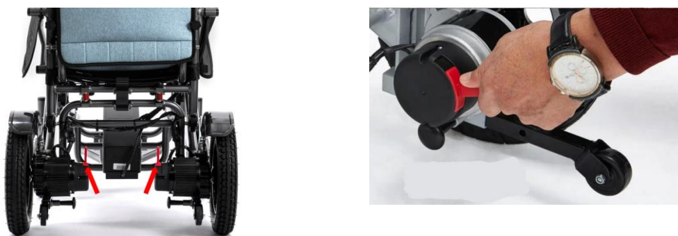
Obrázek11: Spojky (červené páčky) na motorech zadních kol
